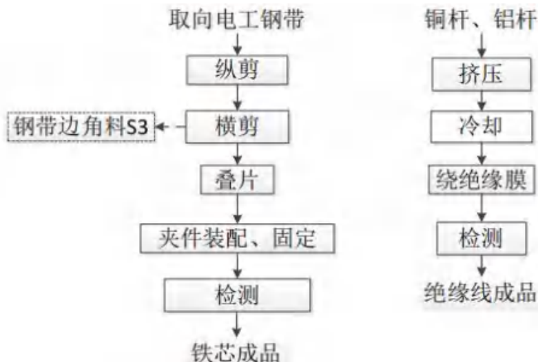
图 2.3.5-10 铁芯、绝缘线生产工艺及产污环节图
